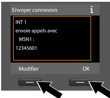
La connexion d'émission actuelle de la base est affichée : **MSN1** pour une connexion au réseau RNIS et **Ligne fixe** pour une connexion à la ligne fixe analogique.
