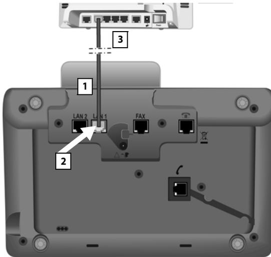
1. Insérer une extrémité du câble Ethernet fourni (Cat 5 avec 2 connecteurs modulaires RJ45 Western) par l'arrière dans l'orifice du boîtier.
