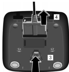
Hvis du skal koble pluggen fra laderen igjen, må du trykke på låseknappen **3** og trekke ut pluggen **4**.
