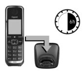
A la livraison, les batteries sont partiellement chargées. Veuillez les charger complètement avant de les utiliser. La batterie est complètement chargée lorsque l'îcône représentant un éclair f s'allume sur l'écran.
