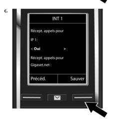
Pour qu'aucun appel ne soit signalé sur la connexion VolP **IP 1** du combiné :
