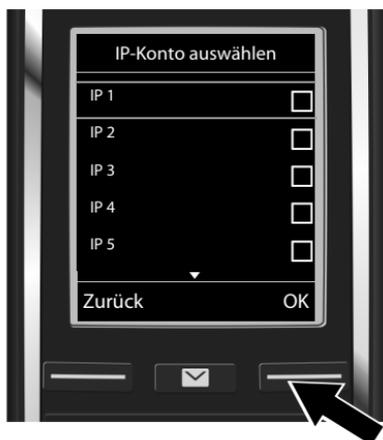
Im Display wird eine Liste mit allen möglichen IP-Verbindungen angezeigt (IP 1 bis IP 6). Bereits konfigurierte VoIP-Verbindungen sind mit  markiert.
