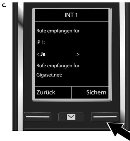
Sollen am Mobilteil keine Anrufe an die VoIP-Verbindung **IP 1** signalisiert werden:
