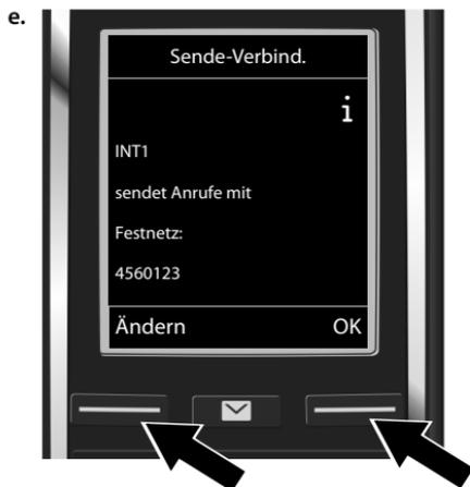
Es wird die aktuell für das Mobilteil eingestellte Sendeverbindung angezeigt:
