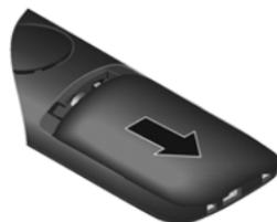
Снятие крышки аккумуляторного отсека
