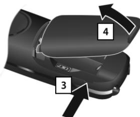
Si vous devez **rouvrir le couvercle de batterie** pour remplacer les batteries :
