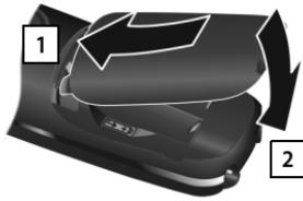
▶ Сначала установите верхний край крышки отсека для аккумуляторов **1**.
