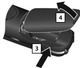
Чтобы открыть крышку отсека для аккумуляторов, например для замены аккумуляторов:
