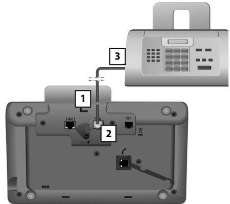
1. Insérer une extrémité du câble de raccordement du fax par l'arrière dans l'orifice du boîtier.
