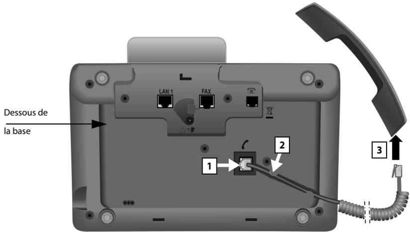
1. Insérer le connecteur qui se trouve à l'extrémité longue du cordon non spiralée dans la prise signalée par l'icône ☎ sur le dessous de la base.
