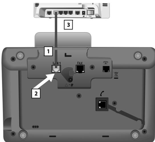
1. Insérer une extrémité du câble Ethernet fourni (Cat 5 avec 2 connecteurs modulaires RJ45 Western) par l'arrière dans l'orifice du boîtier.
