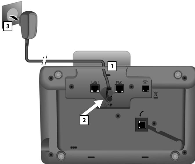
1. Insérer le petit connecteur du câble réseau par l'arrière dans l'orifice du boîtier.
