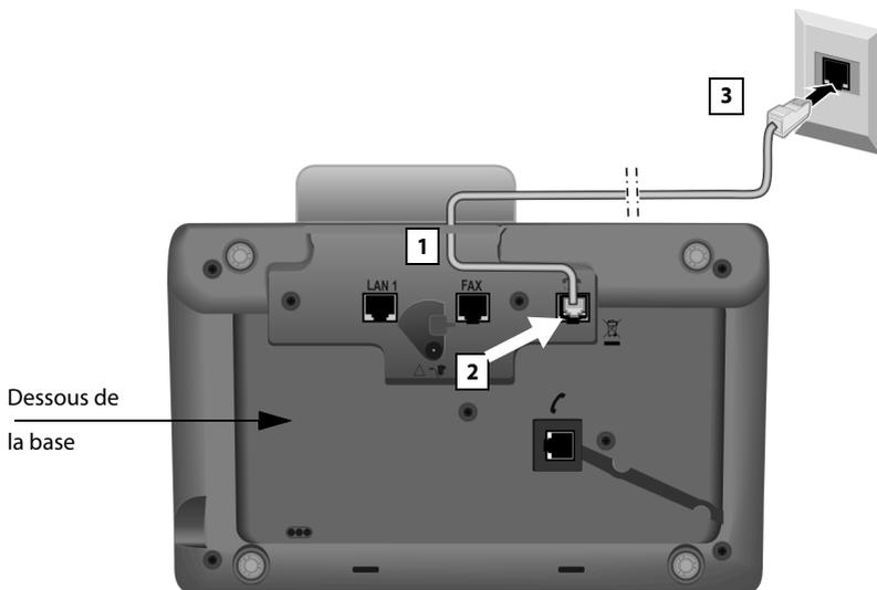
1. Introduire une extrémité du cordon téléphonique (à 8 broches avec 2 connecteurs Miniwestern 8/8) par l'arrière, dans le conduit du boîtier.
