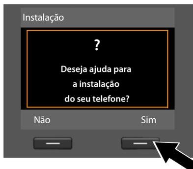
► Prima a tecla de função **Sim**, para iniciar a instalação.
