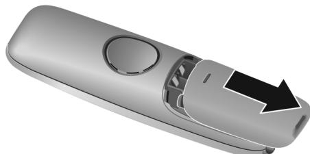
Hvis du skal åpne batteridekselet igjen, f.eks. for å bytte batterier, tar du tak i rillene oppå dekselet og skyver det nedover.
