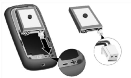
È necessario posizionare il connettore in modo tale che il cavo rosso si trovi sul lato esterno del vano batteria, lato contrassegnato con + ed il cavo nero si troverà ovviamente verso l'interno del vano batteria, lato contrassegnato con -. Nota: lo spinotto entra nel connettore solo se è correttamente posizionato, non esiste il rischio di invertirlo erroneamente. In caso di difficoltà di inserimento capovolgere il connettore, probabilmente si sta cercando di inserirlo per il verso sbagliato.
