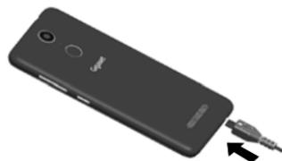
Durante el proceso de carga, el LED de mensajes se enciende en rojo (→ p. 3). El dispositivo estará cargado cuando el LED de mensajes se encienda en verde y el icono de carga **1** en la barra de estado esté completo.
