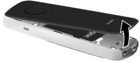
Zum **Wechseln des Akkus** mit dem Fingernagel in die Mulde im Gehäuse greifen und den Akku nach oben ziehen.
