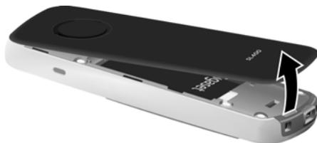
Per **cambiare la batteria** afferrare con l'unghia nell'alloggiamento del vano batterie e sollevare il pacchetto batterie verso l'alto.
