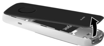
Når du skal **bytte batteri**, setter du neglen i fordypningen i apparatet og drar batteriet opp.
