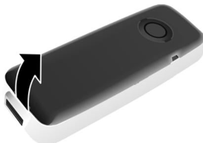
Pour **changer la batterie**, insérer un ongle dans l'encoche du boîtier et tirer la batterie vers le haut.
